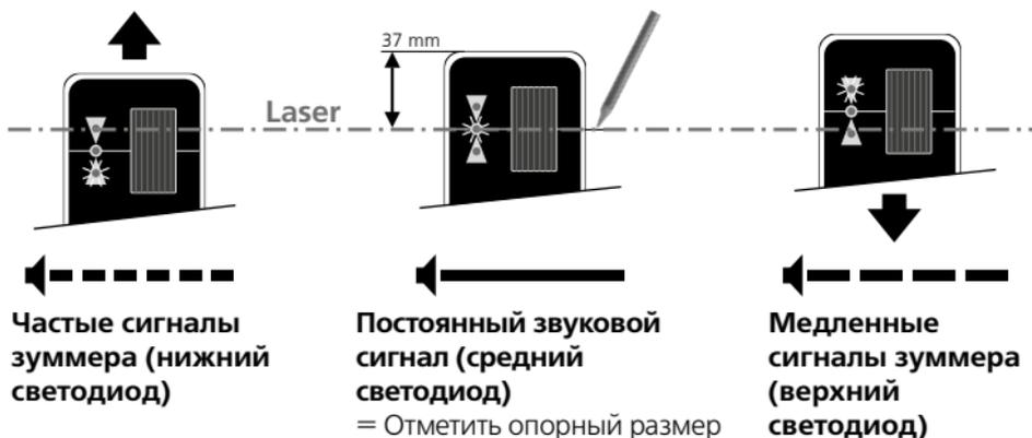
**!** Наибольшую интенсивность света лазерный луч имеет в центре, а ближе к краям луч тускнеет. В результате может уменьшиться максимальный диапазон приема лазерного приемника.
