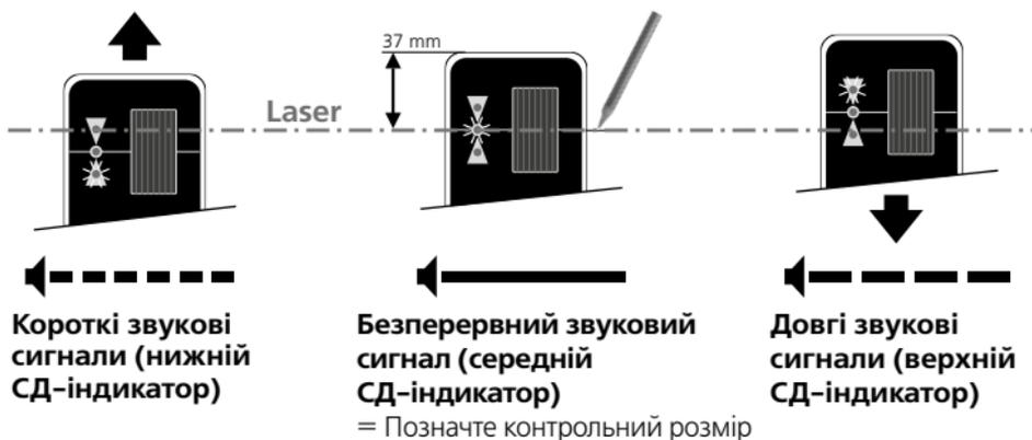
**!** Найбільшу інтенсивність світла лазерний луч має в центрі, а ближче до країв луч тускніє. Таким чином можна зменшити максимальну зону прийому лазерного приймача.
